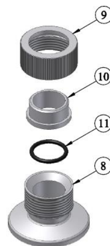
I составные части узла грибкового уплотнения датчика
